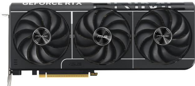
**Die SFF-Ready ASUS Prime GeForce RTX™ 5080 OC Edition 16GB GDDR7 verfügt über drei Axial-Tech-Lüfter und eine Vapor Chamber für optimale Kühlung.**
