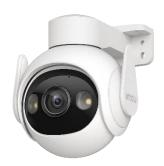
Bewegung erkannt wird, während der Vollfarbmodus mit Hilfe eingebauter Spotlights ein Bild in Vollfarbe darstellt. Der Infrarotmodus sorgt mit fortschrittlichen Algorithmen für klare Schwarzweißbilder, und der Aus-Modus schaltet alle Nachtsichtmodi aus.
