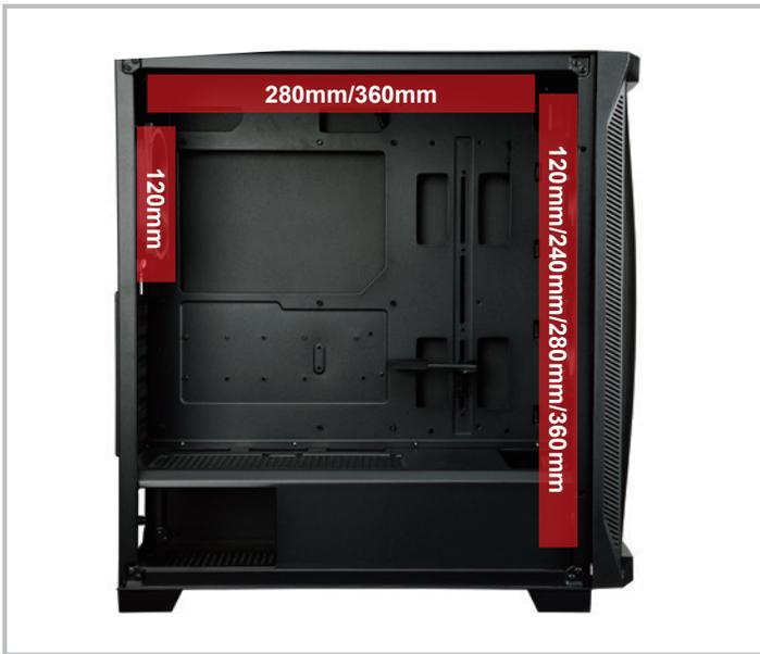
Installation von bis zu zwei 360-mm-Radiatoren oben und vorne, damit das System kühl bleibt.
