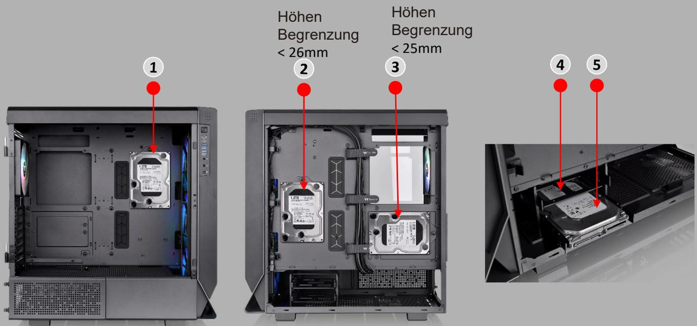
Maximaler Einbau bis zu 5 3.5" HDD
